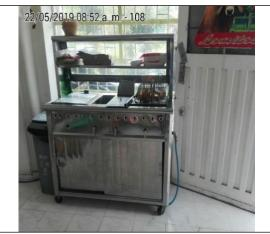
Fotografía No.4 Freidora sin sistema de extracción.
